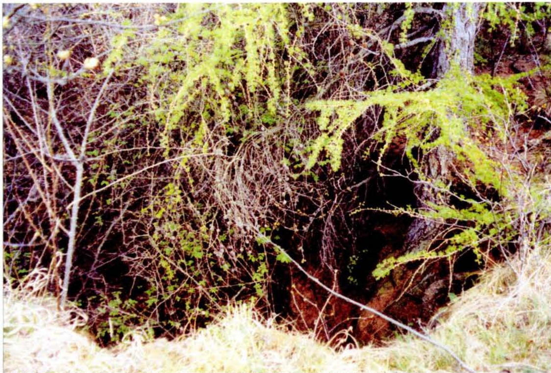
♣Foto 13: Propad po jedné ze starých šachet, nachází se severně od důlního domku.
